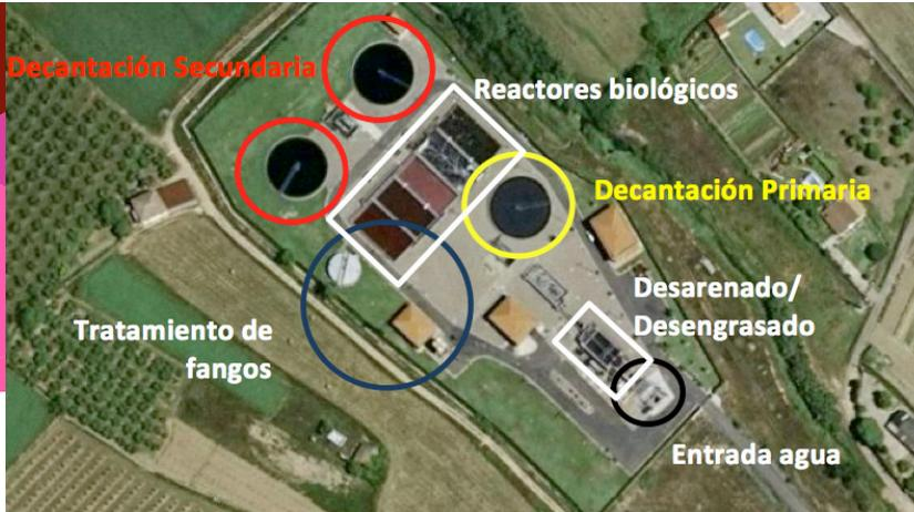
**Depuradora (EDAR):** La depuración de las aguas residuales consiste básicamente en eliminar las impurezas que se han ido acumulando en el agua usada; paso previo para el retorno del agua al medio natural, río Jalón.
