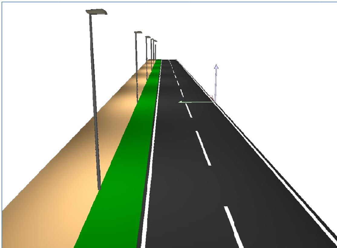
Imagen 36. Recreación 3D de nueva sección proyectada para antigua NII con resultados de alumbrado previsto
