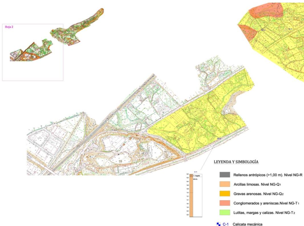
**Imagen 28. Extracto del plano de caracterización geotécnica del terreno de la parte sur del sector**
